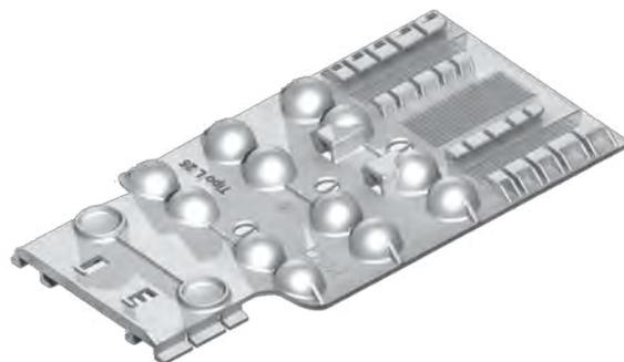
Cada elemento espaciador representa una sección flexible que tiene un tirante macho dentado en un extremo y una ranura hembra dentada correspondientemente en el otro. En su montaje no interviene absolutamente ninguna pieza metálica. Este diseño permite realizar ajustes in situ para cualquier variación dentro del rango de diámetro exterior. Junto con su flexibilidad, cubren todo tipo de tuberías desde el rango de diámetro exterior de 1,65 pulgadas (42 mm) en adelante.
